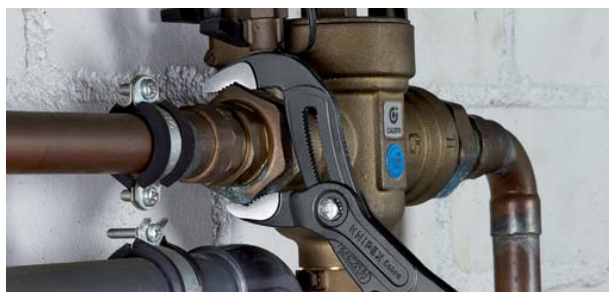
Zuby přesazené proti směru otáčení způsobují samosvorný efekt a zabraňují sklouznutí po obrobku.
