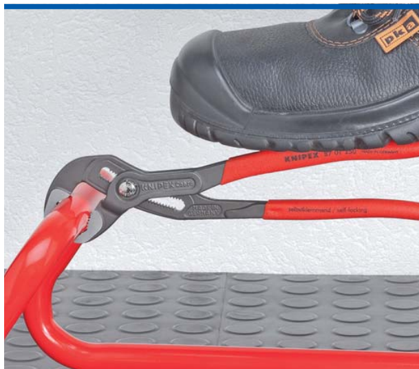
Zuby přesazené proti směru otáčení způsobují samosvorný efekt a zabraňují sklouznutí po obrobku.
